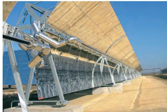
Lazo de colectores cilindro-parabólicos de la planta Solnova 1. Fuente: Abengoa.
